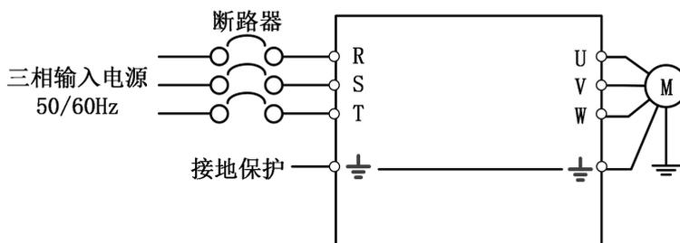
所有外部功率配线的规格和安装方式需要符合当地法规及相关 IEC 标准要求。
